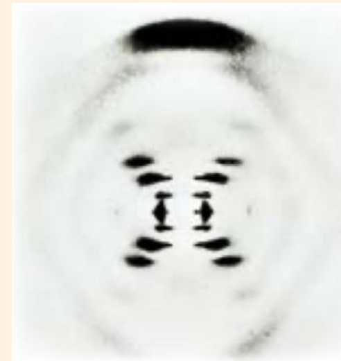
DNA的X射線衍射圖像
